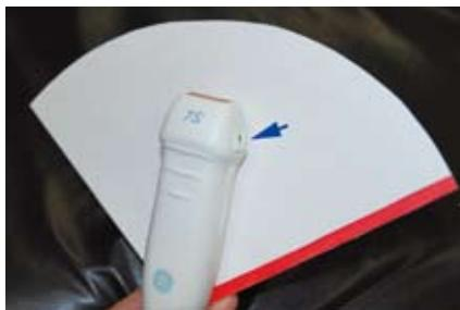
図3 プローブマーカーと超音波ビーム面
